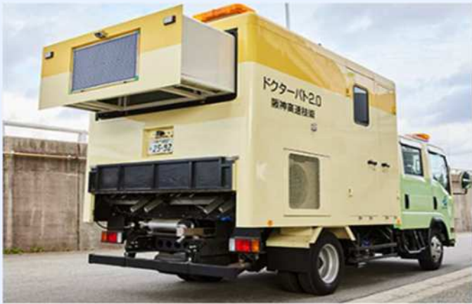
路上点検車「ドクターパト2.0」による定期点検
