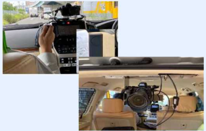
車載カメラを活用した日常点検
