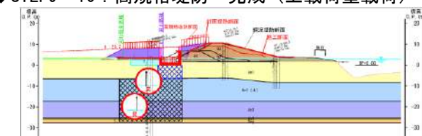
◆STEP9・10：高規格堤防・完成（上載荷重載荷）
