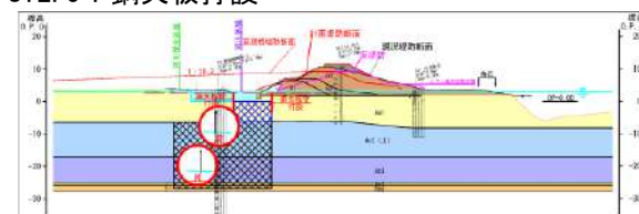
◆STEP5：鋼矢板打設
