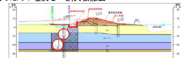
◆STEP8：埋戻し・鋼矢板撤去*
