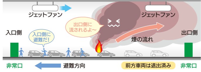
■ 渋滞しているときの煙の流れ (ジェットファンの風向きを前後に制御)
