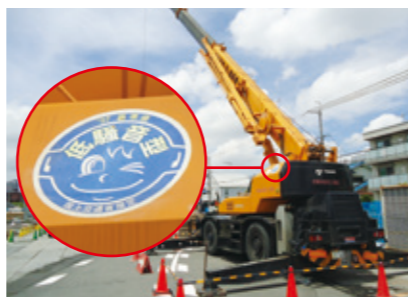
(上) 現場の出入口で、通行される方の安全に注意した車両誘導を行っています。(右) 国土交通省が「低騒音型建設機械」に指定した建設機械に貼られるラベル。
