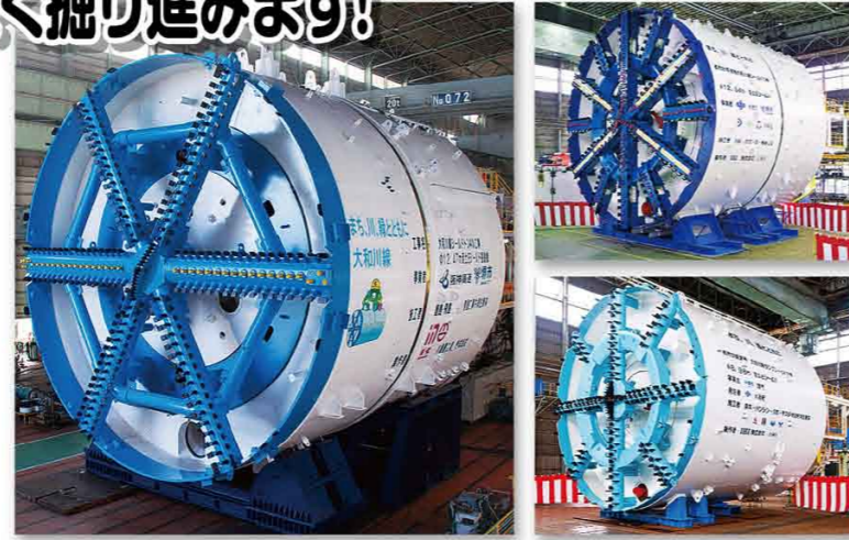
左: [阪神高速道路株式会社施工区間] 本線用シールドマシン 右: [大阪府施工区間] (上)本線用シールドマシン (下)ランプ部用シールドマシン
