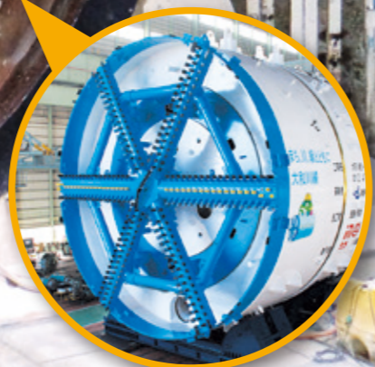
初めは青だったマシンの“顔”も、土とサビで茶色に変わっています。これからすり減った刃の交換などの調整を行います。
