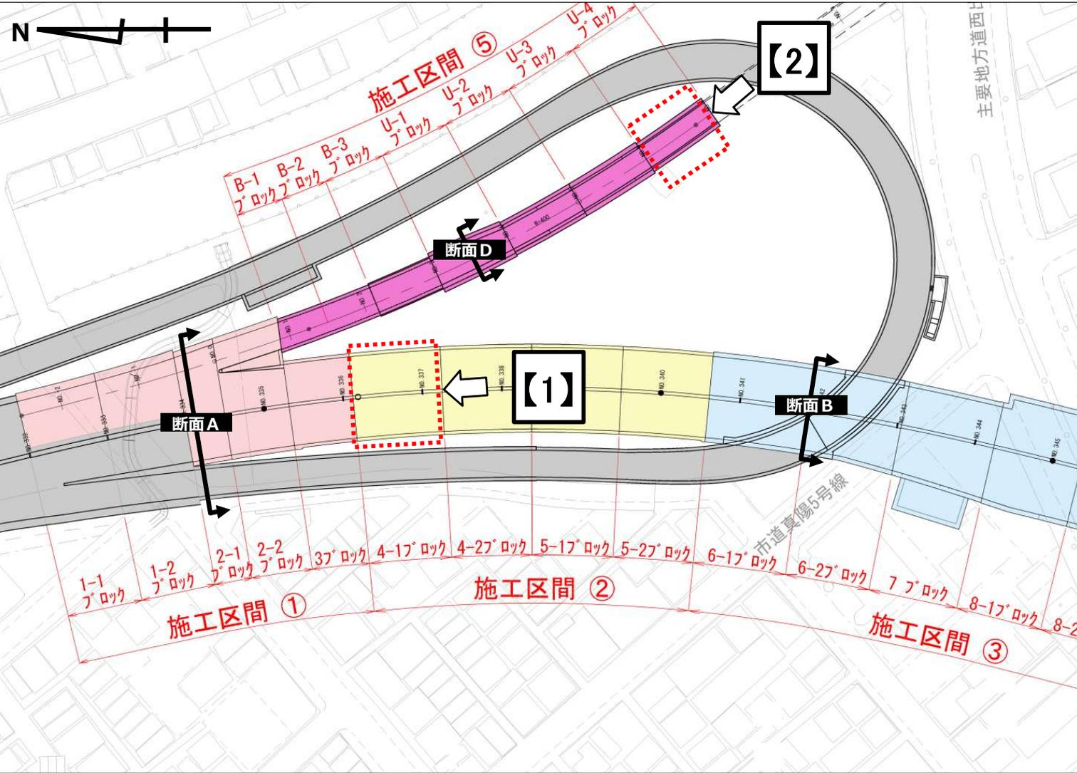
【1】施工区間②4-1ブロック頂版コンクリート打設完了
