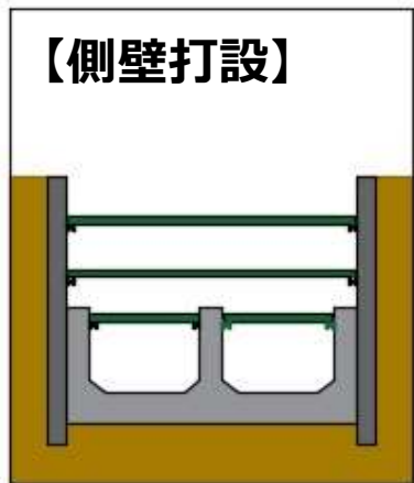
(6) 切梁を外し、側壁を打設する。
