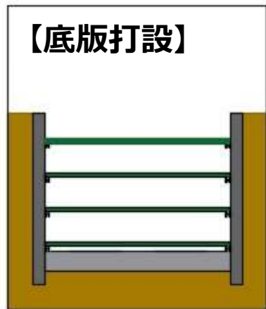
(5) 本体工の底版を打設する。
