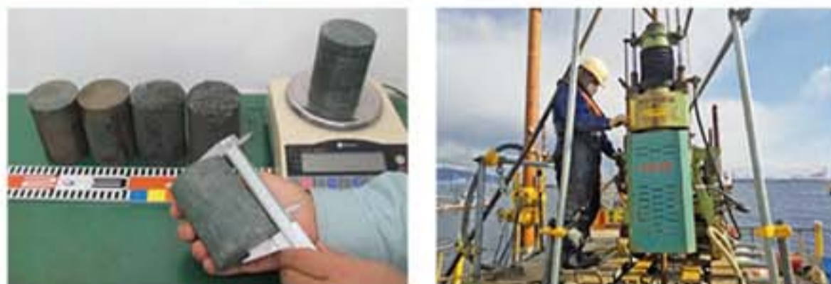
実際に採取した海底の土。複数箇所から採取し、より正確に海底地質を調査します。
