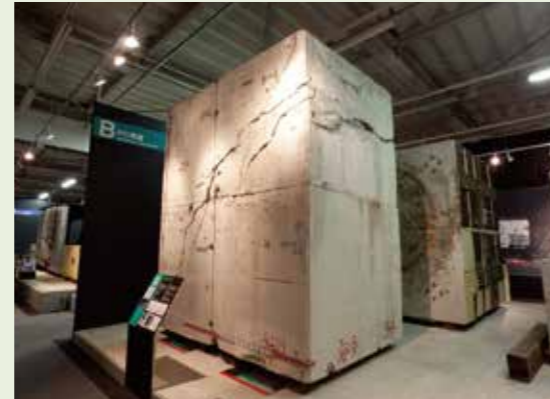
被災した橋脚の展示
