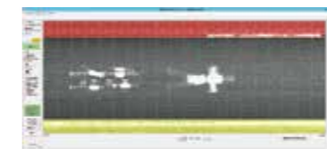
AIを用いた舗装ひび割れ検出技術
