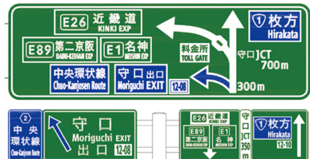
分かりやすい案内標識・カラー舗装
