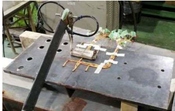
図3 局所加熱実験の状況
