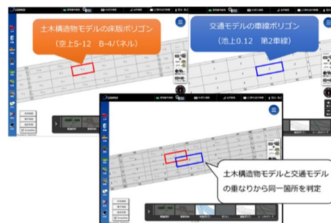
図-1 土木構造物・交通モデルの重なり
