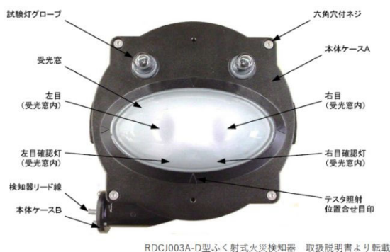
図-1 火災検知器の構造 1)
