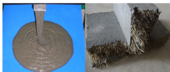
写真-5 UFC=超高強度繊維補強コンクリート
