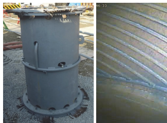
写真-10 鋼管内洗浄機（左）、管内洗浄状況（右）
