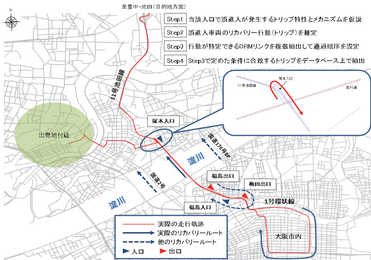
図-8 プローブデータを活用した誤進入事案抽出のイメージ（11号池田線（大阪市内方面）塚本入口での間違い例）
