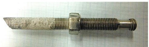
写真-2 臨時点検時脱落ボルト例
