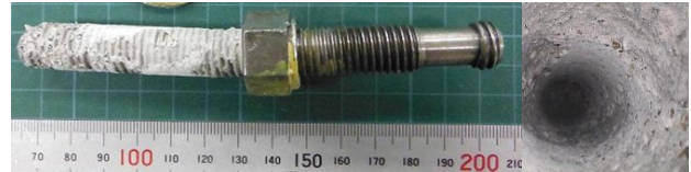
写真-4 トルク調査時抜けだしボルトと孔壁
