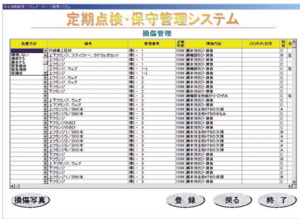
図-14 損傷管理画面
