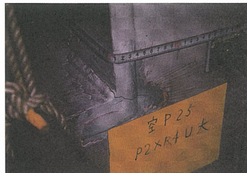
図-4 空P25損傷部磁粉指示模様
