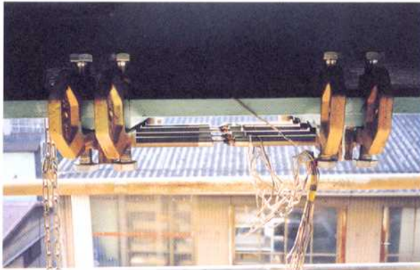
写真-1 実橋での疲労試験状況
