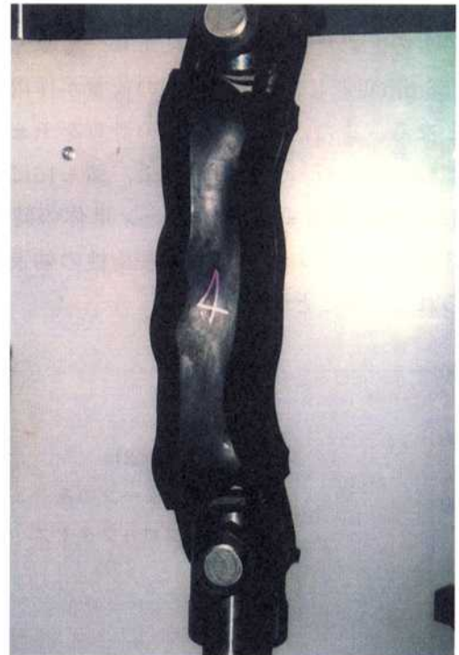
写真-6 衝撃試験供試体 (試験後)
