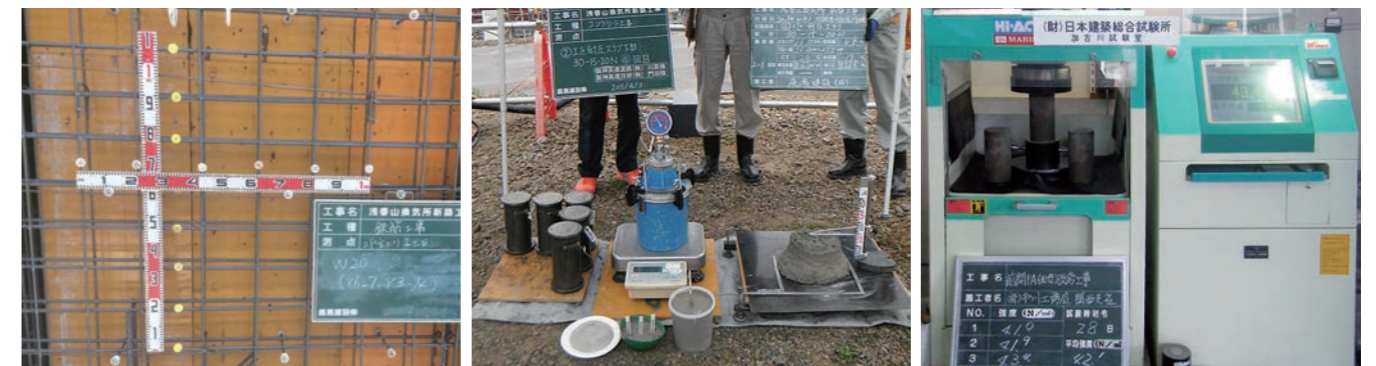
鉄筋の配筋検査(左) / コンクリートの受入検査(中) / コンクリートの強度試験(右)
