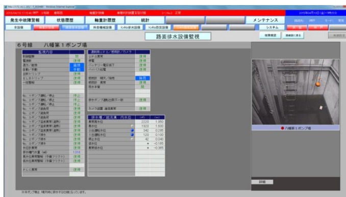
ポンプ稼働状況・水位・水槽内映像
