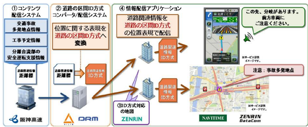
官民連携の安全走行支援情報配信実験プロジェクト 「Project Z NAVI de HANSHIN!」のスキーム
