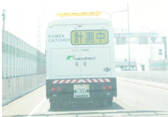
路面点検車による調査状況 舗装打替作業
