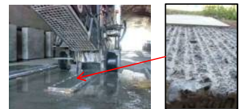
切削面を想定した試験体作製
