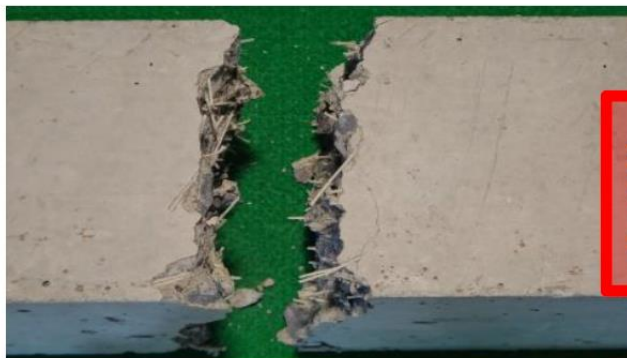
HFを混入することでSF同レベルの曲げ特性
