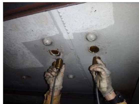
写真一透過法による超音波伝播速度調査
