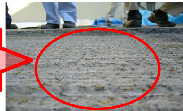
軽く熱を与えるだけで露出繊維が溶解
