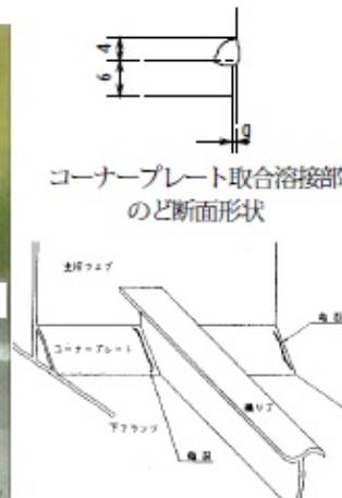
コーナープレート 取り付け部のき裂
