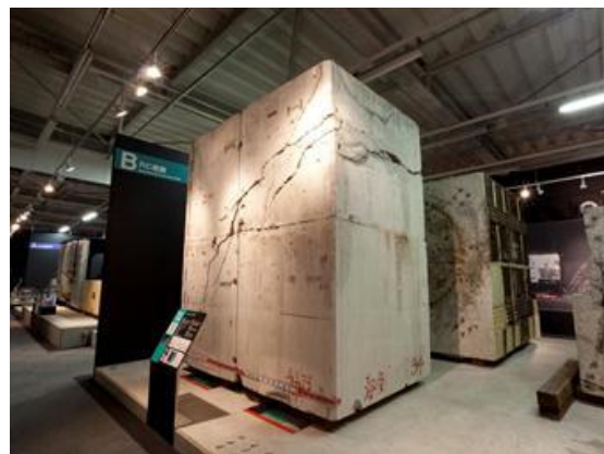
展示状況 鉄筋コンクリート橋脚
