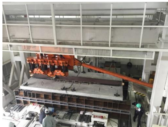
損傷したRC床版パネルの輪荷重走行試験
