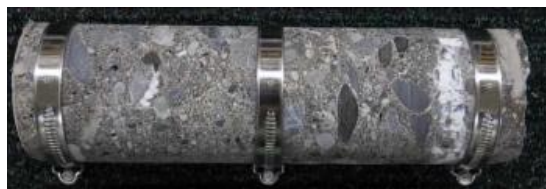
ゲルの滲出状況
