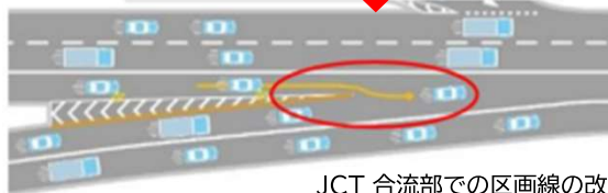
JCT 合流部での区画線の改良
