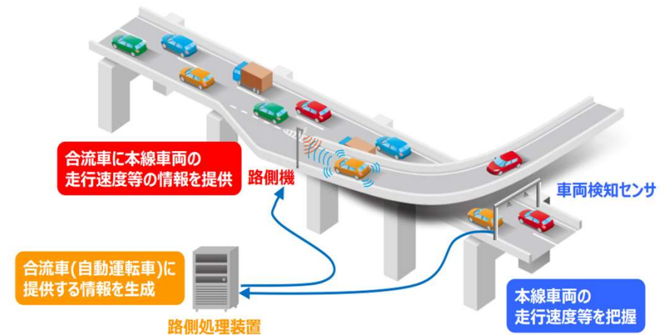
自動運転 合流支援技術 出典:国土技術政策総合研究所HP
