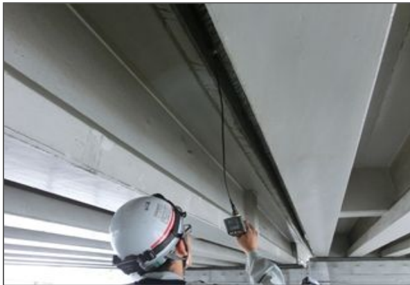
〔ファイバースコープによる狭隘部の点検〕
