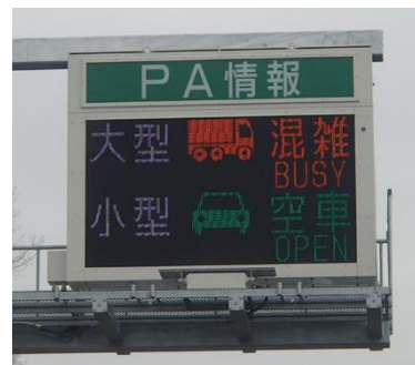
満車表示板の設置
