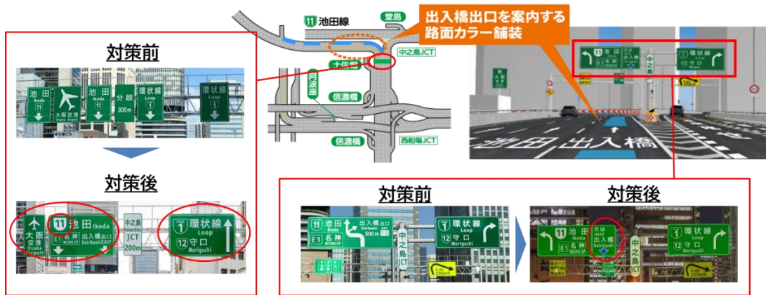
1号環状線 出入橋出口分岐・中之島 JCT 分岐付近の安全対策
