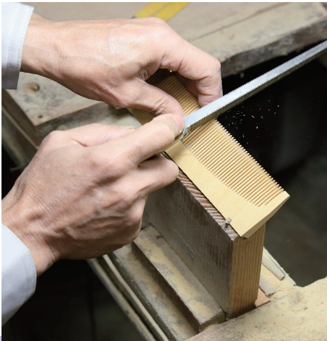
丸いこざりて歯づくりした櫛の歯1本1本は、四角い棒状。それを「がんざり」というやすりで、歯の先端を細く、根本にかけて細長い三角形になるよう削っていく。最初はがんざりの角度を高く持って歯先を削り、徐々に角度を下げて根本まで丁寧に削る。「これが、櫛づくりで最も大切な作業です」。「常にいかに工夫してより良いものをつくらうかと考え、工夫を続けているので、自分がこれまでに手掛けた櫛は、いつごろつくった櫛なのか見ればわかります」
