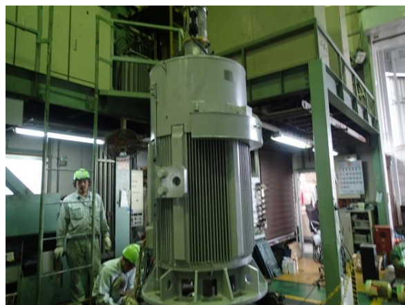
島屋換気所 1号排風機分解整備（ケーシング分解、電動機工場検査）
