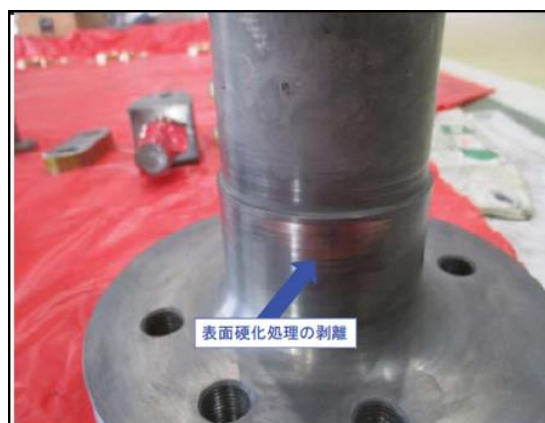
大開換気所1号排風機分解整備（動翼可変機構分解、駆動軸確認）
