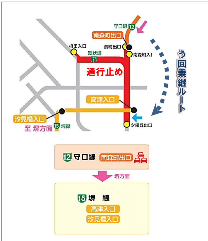
阪神高速 環状線(南行)終日通行止め工事の事例
