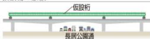
①仮設桁の敷設
