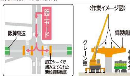
③鋼製橋脚の架設(夜間)
