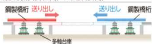
④鋼製橋桁(側径間)の架設(夜間)
