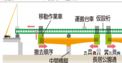
②既設コンクリート橋梁の撤去
