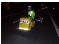
舗装の上から鋼床版き裂位置を 特定できる鋼床版検査装置
