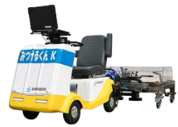
舗装の上から鋼床版き裂位置を 特定できる鋼床版検査装置
