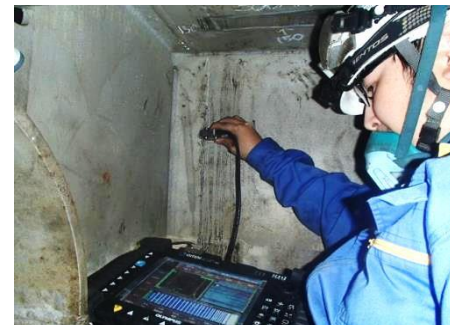
フェイズドアレイ法による詳細調査
