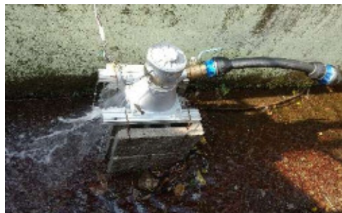
「エネルギーの地産地消」をテーマに地域に流れる用水路を使った小水力発電
