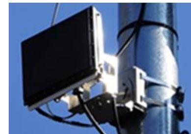
電波レーダ式車両検知器
