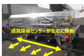
従来の鋼床版下面からの点検に加えて、舗装上面からちき裂を特定できる非破壊検査装置を適用（H28～）
