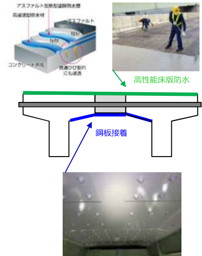
上面：高性能床版防水、下面：鋼板接着
