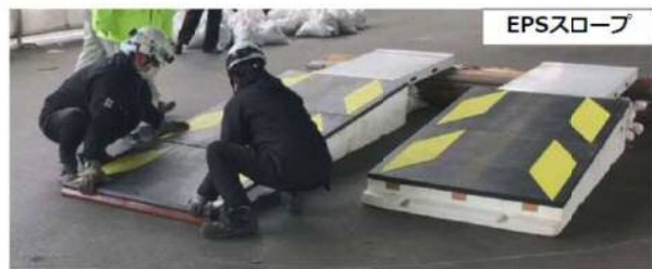
各段差の応急復旧に対応できる資材の確認実験状況
