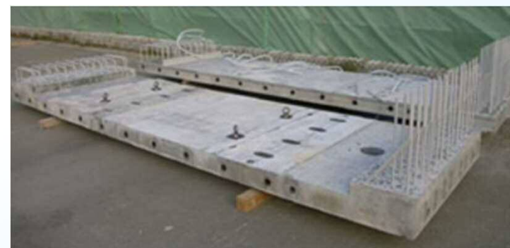
試製作したUFC道路床床版
