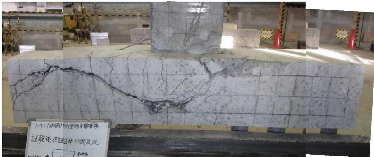
実験後の切断面の状況
