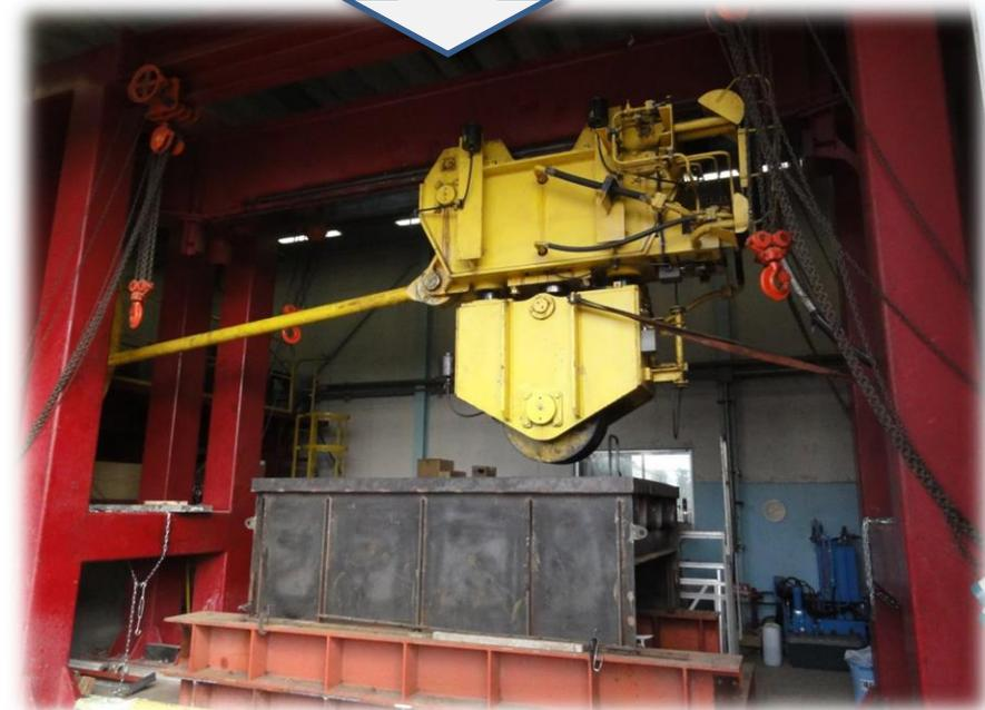
輪荷重疲労試験機による評価
